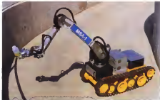
Fig. 2 - SMT-1: Piattaforma mobile con telecomando elettronico e sei gradi di libertà con comando «master/slave». SMT-1 per interventi nel campo della sicurezza e della manipolazione di oggetti sospesi o pericolosi
